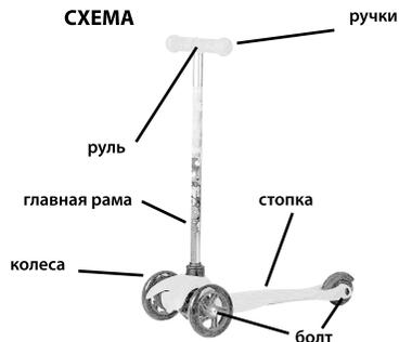
ЧТОБЫ ПРОВЕРИТЬ, ПРАВИЛЬНО ЛИ УСТАНОВЛЕНА РУЛЕВАЯ КОЛОНКА, НЕОБХОДИМО ПЕРЕВЕРНУТЬ САМОКАТ НИЖНЕЙ СТОРОНОЙ ОСНОВАНИЯ ВВЕРХ И ПРОВЕРИТЬ, ПРАВИЛЬНО ЛИ ЗАБЛОКИРОВАЛСЯ (ЩЕЛКНУЛ) БЛОКИРОВОЧНЫЙ ЭЛЕМЕНТ С НИЖНЕЙ СТОРОНЫ САМОКАТА (ВОЗЛЕ ПЕРЕДНИХ КОЛЕС)
